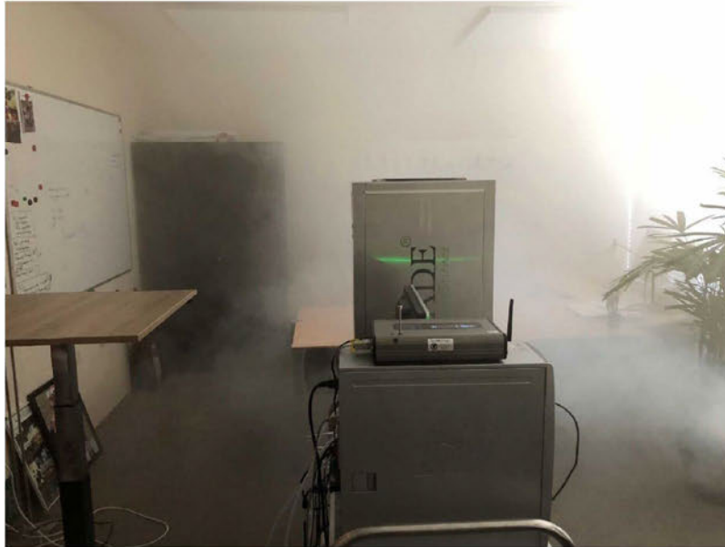
Aerosolgeneratie in kleine kantoorruimte
